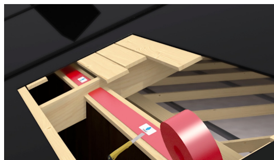
2. Skär av brandstoppet med passande längd. Bandet skall passa snävt mellan takstolarna. Eventuell skarvning av brandstoppet görs enkelt kant i kant utan något överlapp.
